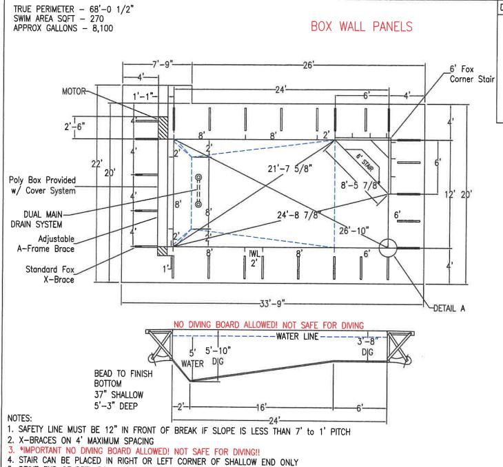
5. DRIVE END OF REEL BOX CAN BE PLACED IN RIGHT OR LEFT CORNER OF DEEP END ONLY
